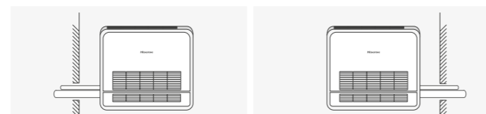
Τοποθέτηση με τον τοίχο στα αριστερά.
